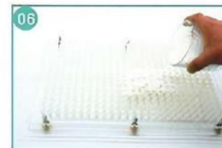
Высыпьте капсулируемый материал на пластину корпуса (1), наполненную длинными половинками капсул
