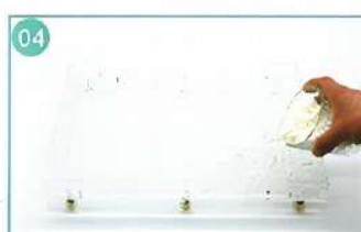
Высыпьте длинные половинки капсул в фидер (3). Встряхните обе пластины, чтобы капсулы заполнили все отверстия. Снимите фидер (3) и вручную переверните капсулы, расположенные наоборот
