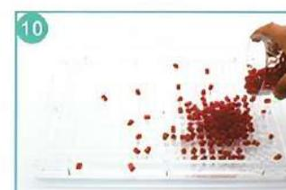
Высыпьте короткие половинки капсул в фидер (3). Встряхните обе пластины, чтобы крышечки капсул заполнили все отверстия. Снимите фидер (3) и вручную переверните капсулы, расположенные наоборот
