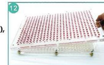
Переверните плотно фиксируя вместе среднюю пластину (4) и колпачковую и накройте пластину корпуса (1) с заполненными капсулами
